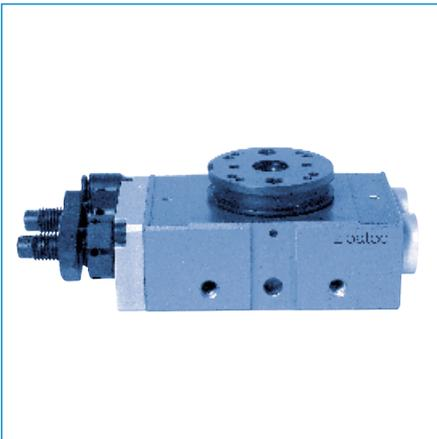
Rotationsmodul mit Zahnstange-Ritzel-Antrieb mit stufenloser Drehwinkelverstellung über den gesamten Schwenkbereich. Durch den modularen Aufbau und Mittendurchgang sind die Rotationsmodule zum Aufbau von Greif-Dreh-Modulen ohne mitdrehende Energieleitungen vorbereitet.
