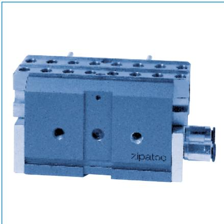
Kompaktes, pneumatisches Langhub-Parallel-Greifmodul in zwei Baugrößen. Durch den grossen Parallelhub und die Führung der Greiferbacken über die gesamte Gehäuselänge ist der Anbau sehr langer Greiferfinger bei hoher Lastaufnahme in allen Richtungen möglich.
