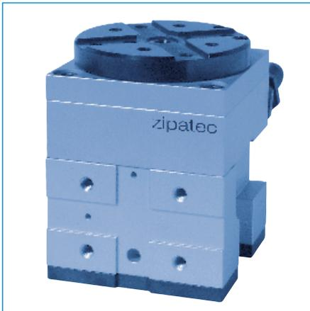
Kompaktes und leistungsstarkes Rotationsmodul mit direktem Antrieb des Drehtellers durch einen integrierten Schwenkflügelzylinder zur Realisierung von hochpräzisen Dreh- und Schwenkbewegungen.
