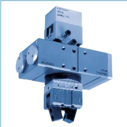
Die modular aufgebauten Greifmodule sind in Antrieb und Greiferbausatz getrennt. Dieser Vorteil kommt bei der Kombination zu Greif-Drehmodulen voll zum Tragen. Der Antrieb kann inclusive der darin integrierbaren Endlagenabfragen an der Unterseite der Rotationsmodule montiert werden, wodurch keine Energieleitungen mitdrehen.
