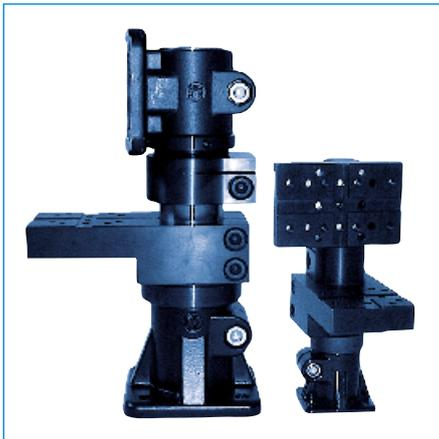
Das Montagezubehör besteht grundsätzlich aus zwei Baureihen. Das System 30 mit Säulendurchmesser 30 mm ist für die Montage von Linearmodulen LM 49 als Basismodul vorgesehen. Beim Einsatz der Linearmodul-Baureihen LM 70 und LMBZ (F) ist dagegen das System 50 mit Säulendurchmesser 50 mm hervorragend geeignet, die höheren Belastungen aufzunehmen.
